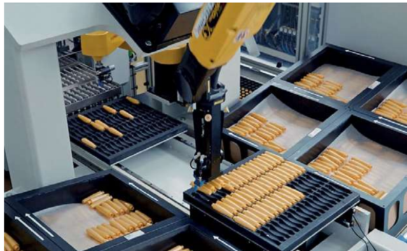
Ein Fanuc-Roboter vom Typ M-10iD/10L platziert mehrere Kunststoffbehälter gleichzeitig in dafür vorgesehenen Trays. (Bilder: Fanuc)
